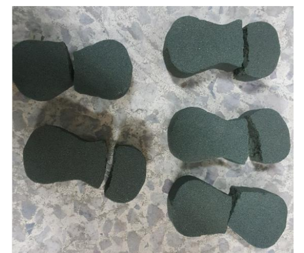
Figure 7. 인장 강도 시험 완료 후 시험체 모습
