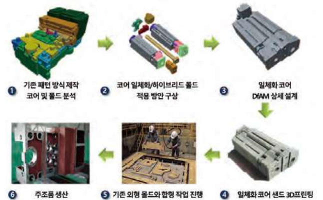
그림 2. 직경 210mm 엔진 프론트엔드 박스 사례
