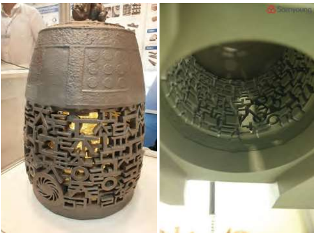
그림 11. 영신특수강 조형물 및 일체형 샌드 3D 프린팅 몰드
