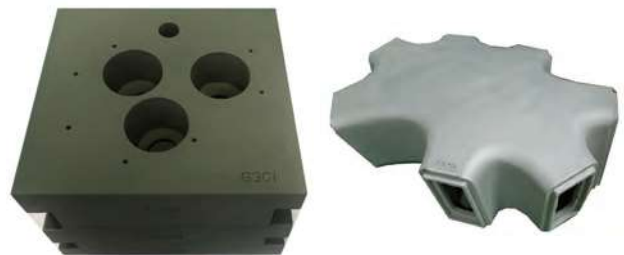
그림 8. 비정형 커튼월 노드 샌드 프린팅 몰드 및 주조품
