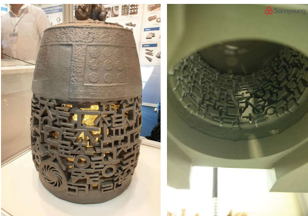
그림 11. 영신특수강 조형물 및 일체형 샌드 3D 프린팅 몰드
