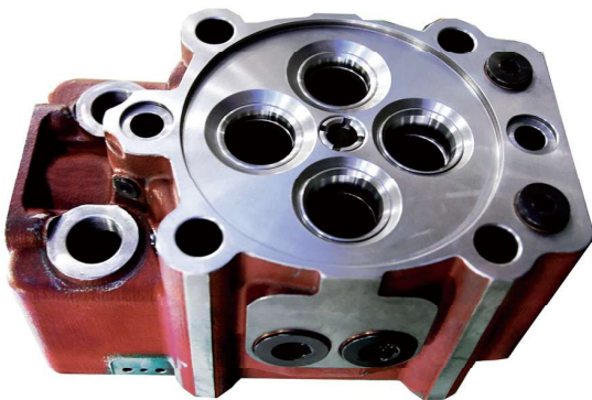
그림 1. 직경 170mm 엔진 실린더 헤드 사례. (a) DfAM 몰드 일체화 설계 (b) 샌드 3D 프린팅 몰드 (c) 샌드 3D 프린팅 몰드로 제작한 실린더 헤드 완성품
