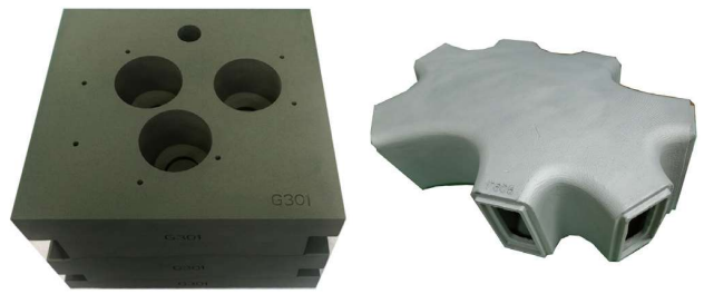
그림 8. 비정형 커튼월 노드 샌드 프린팅 몰드 및 주조품
