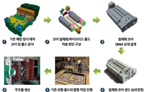
그림 2. 직경 210mm 엔진 프론트엔드 박스 사례
